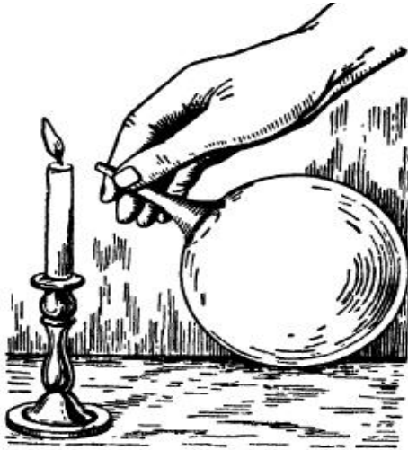
شکل ۶۸ - قشر حباب صابون هوا را با فشار بیرون می‌دهد.
